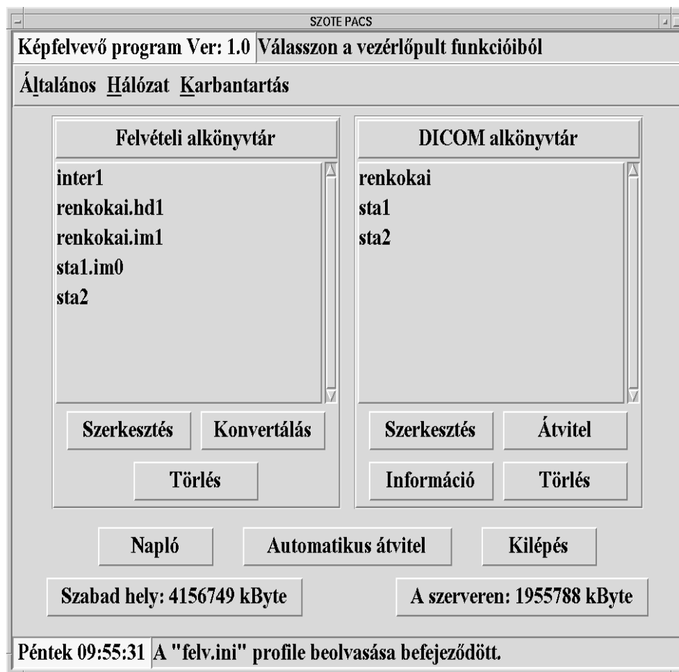
2. ábra. A képfeltevő állomások Vezérlőpultja. Innen lehet kérni a vizsgálatok konverzióját, szerkesztését és átvitelét kézi vagy automatikus üzemmódban. A Felvételi alkönyvtárban várnak a konvertálandó vizsgálatok, a DICOM alkönyvtárban pedig a DICOM formátumra konvertáltak.
