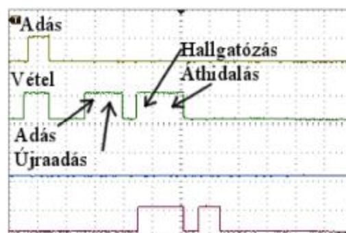
4. ábra A rádiók aktivitása a 3-as számú eszköz kikapcsolásakor. A 2-es csomópont lehallgatja a 3-as adását és egy áthidaló adást tesz a 4-es csomópont felé a 3-as újrapróbálkozási időéréseben.
