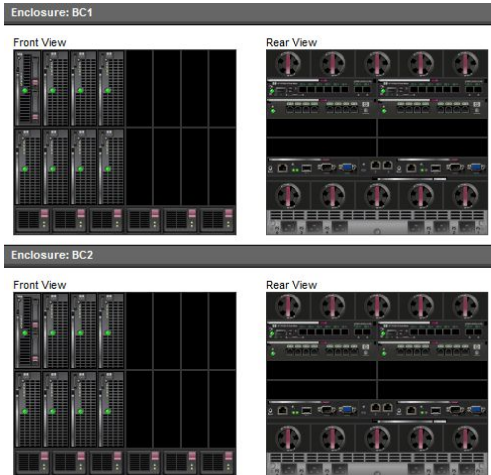
3. ábra: A blade keretek fő alkotóelemei
